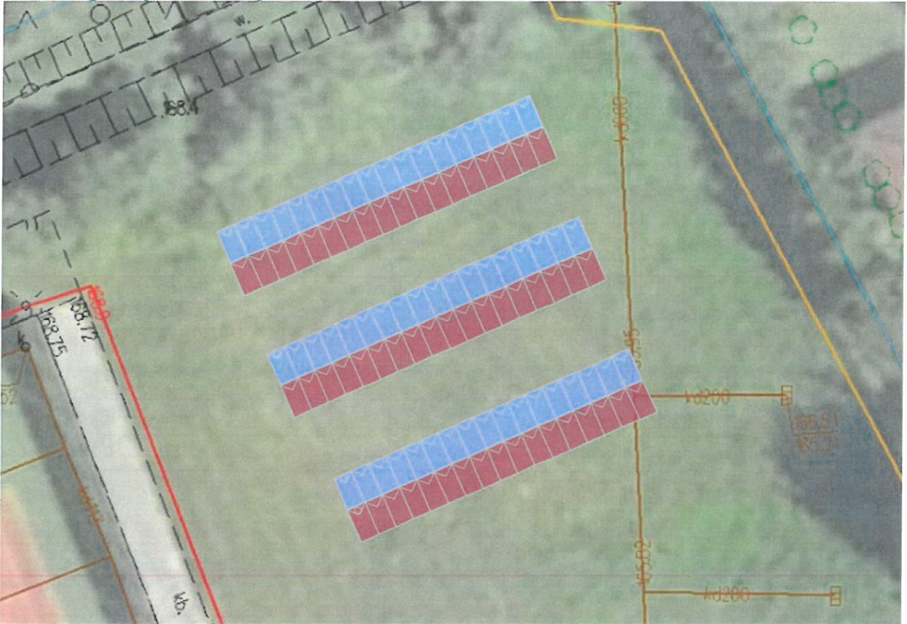
Rysunek 1: Umieszczenie generatora fotowoltaicznego i grupy przetwornic
