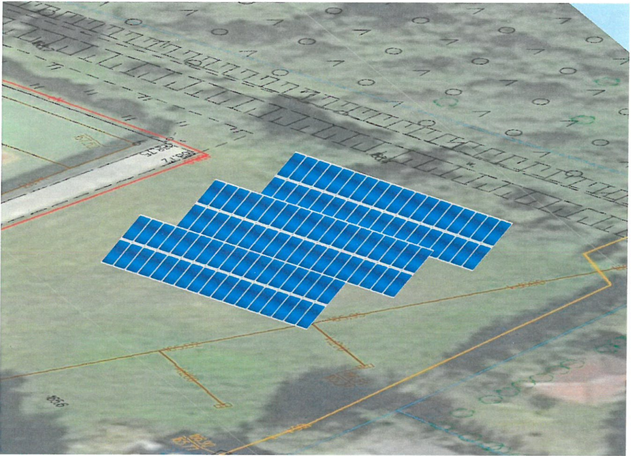
Rysunek 2: Realistyczny widok instalacji systemu
